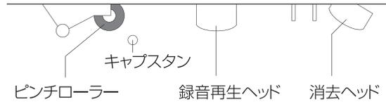
ヘッドの消磁を行うには市販の消磁器をお使いください。カセットタイプの消磁器をお使いになるときは、必ず再生ボタンのみを押し込んで消磁してください。詳しくはヘッド消磁器の説明書をご覧ください。
