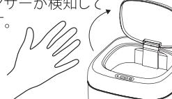
※注意:電子ペールは床に置いて使用する。照明直下のテーブルの上や机の上に置くとセンサーの検知の妨げになることがあります。
