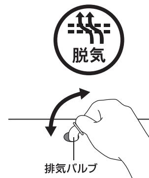
※連續で2分以上脱気する場合は、モーターを保護するために一旦自動的に休止します。5分間休止してから再度作業してください。
