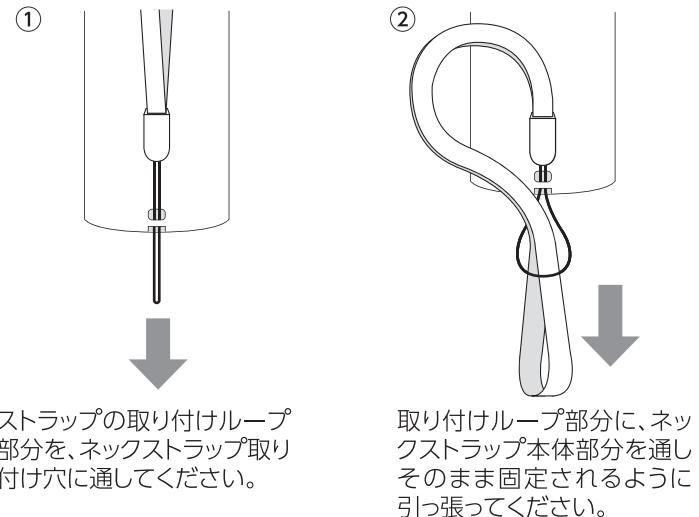
ストラップの取り付けループ部分を、ネックストラップ取り付け穴に通してください。
