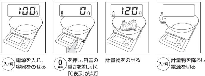
※風袋引き(追加計量、0表示機能)使用時、「0表示」が点灯します。
