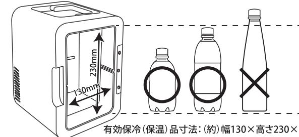
有効保冷(保温)品寸法:(約)幅130×高さ230×奥行き140mm
