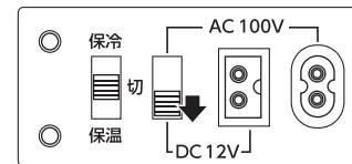
●自動車内でご使用になるときは、必ず付属品の専用DC電源コードで接続してください。自動車内のAC100V電源では、動作不良・故障の原因になる場合があります。
