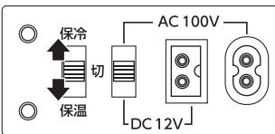
④電源切替スイッチを「DC」側に合わせてください。
