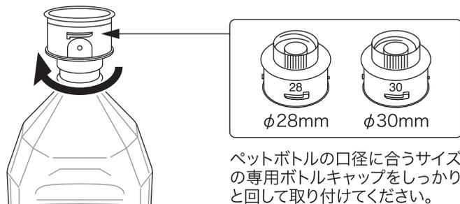
⑤専用ボトルキャップを取り付けたペットボトルを逆さまにして、給水口にセットする。時計回り方向にねじって、しっかりと固定してください。
