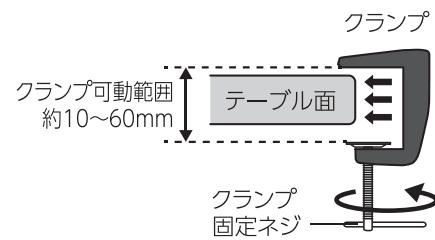
②クランプ固定ネジをしっかりと締めて、テーブルの側面に固定します。
