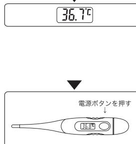
測定が終了に近づくと終了予告ブザーが「ビー、ビー、ビー、...」と1秒間に1回のペースで10秒間鳴り、°C表示が点滅から点灯に変わります(※1)。但し、その後も測定状態は続いている。より正確な測定のためには、更に約2~3分程度測定を継続されることをお勧めいたします。
