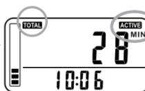
※累計データ表示のとき、すべての計測データのリセット操作ができます。新たに「0」から計測することができます。この場合、すべての計測データ(当日データ、累計データ、メモリーデータ)が消去されます。※リセット操作は、12ページ「データのリセット」をご参照ください。
