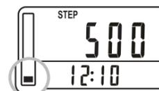
●目標歩数を達成したら、バーグラフは100%を表示し、約30秒間点滅します。
