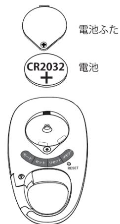
※電池交換をするときすべての設定内容と計測データが消去されます。電池交換したら、再設定をしてください。
