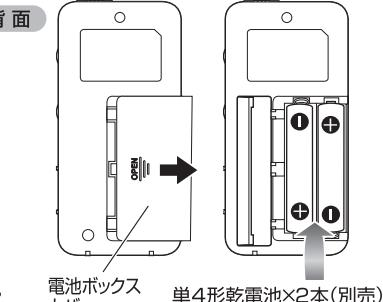
※アルカリ乾電池をご使用ください。マンガン乾電池、充電式乾電池では使用可能時間が短くなります。
