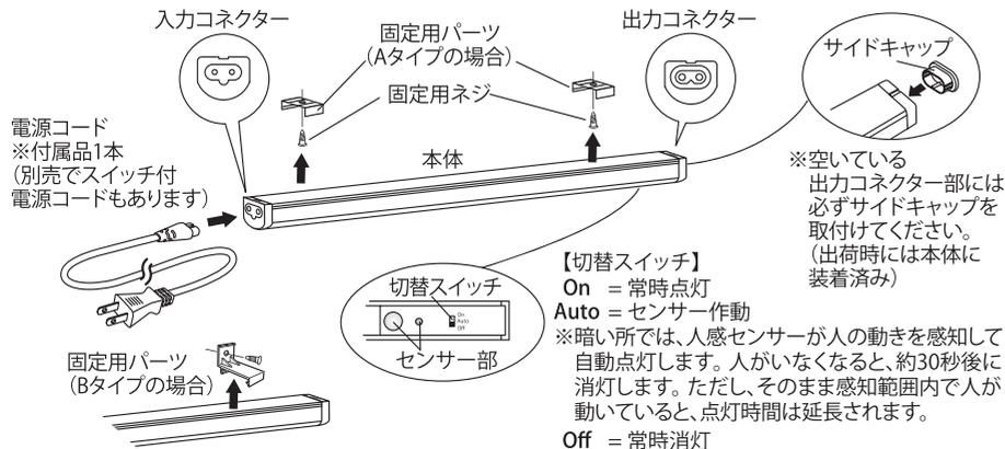
【ご注意】センサー式LEDエコスリムシリーズは最大12台まで連結可能です。ただし、明暗・人感センサーによる電源のOn/Auto/Offの機能は連動しませんのでご注意ください。連結する場合、必ず当社製LEDエコスリムオプションパーツ (別売) をご使用ください。また、センサー式LEDエコスリムシリーズには、LEDエコスリム (スイッチ式) を連結しないでください。
