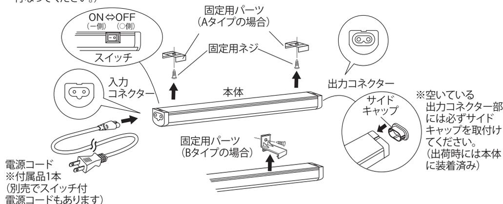
設置状況により、本体スイッチを操作しにくい場合は、別売のスイッチ付電源コードをご使用ください。
