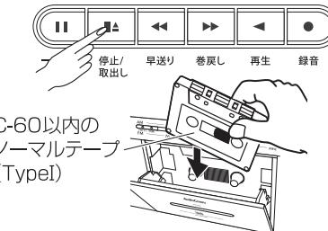
**3** 一時停止ボタンを押した後、録音一時停止状態にします。
