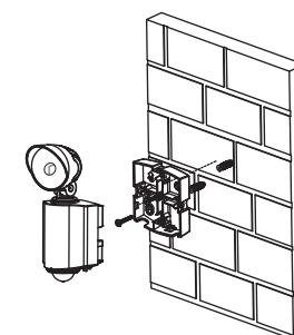
\*木ネジで固定できないモルタルや、コンクリート壁などの場合、ドリルで下穴（直径6mm深さ約30mm）を開けて付属のカールプラグを打ち込んだ後、木ネジで固定してください。
