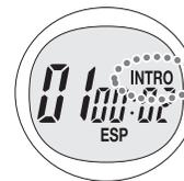
イントロ再生中はディスプレイに「INTRO」が表示されます。また、「INTRO」が点滅している場合は、再生中または一時停止中にイントロ再生を選んだため、待機中であることを示しています。
