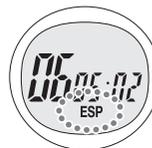
本機はESP(Electronic Shock Protection)機能を装備しています。ESP機能とは自動的に音声データを蓄え音飛びを防ぐ機能で、本機は約60秒間のデータを蓄えます。
