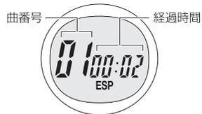
**5** 再生中に再生/一時停止ボタンを押すと、一時停止します(経過時間表示が点滅します)。もう一度押すと再生を再開します。
