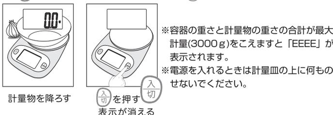
※容器の重さと計量物の重さの合計が最大計量(3000g)をこえますと「EEEE」が表示されます。
