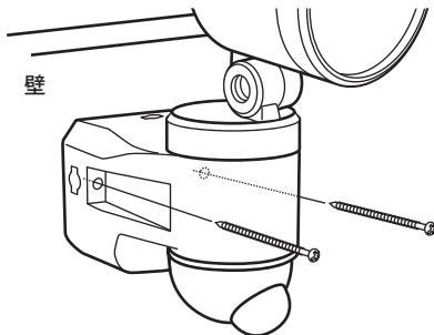
図のように付属のネジ2本を取り付け固定します。
