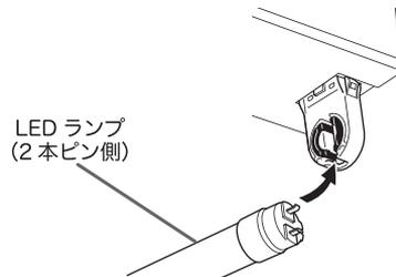
(2) LED ランプを 90 度回して確実に取り付ける。
