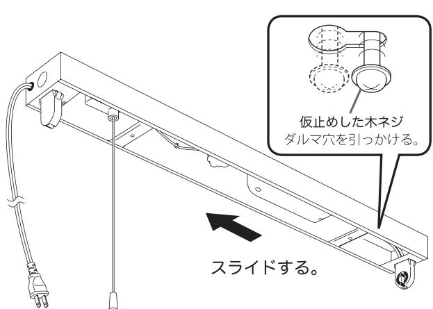
(3) 反対側の木ネジ取付用穴を木ネジ（付属品）で固定する。
