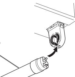
(2) LED ランプを 90 度回して確実に取り付ける。
