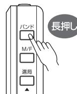
バンド切換ボタンを長押ししてロック機能をオンにすると、ボタン操作ができなくなります(ディスプレイにロック表示が点灯)。ポケットや鞄に入れている時に誤操作を防ぐことができます。ロック機能を解除するには、もう一度バンド切換ボタンを長押しします。
