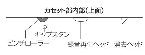
ヘッドの消磁を行なうには市販の消磁器をお使いください。カセットタイプの消磁器をお使いになるときは、必ず再生ボタンのみを押し込んで消磁してください。詳しくはヘッド消磁器の説明書をご覧ください。
