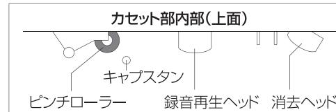
ヘッドの消磁を行うには市販の消磁器をお使いください。カセットタイプの消磁器をお使いになるときは、必ず再生ボタンのみを押し込んで消磁してください。詳しくはヘッド消磁器の説明書をご覧ください。
