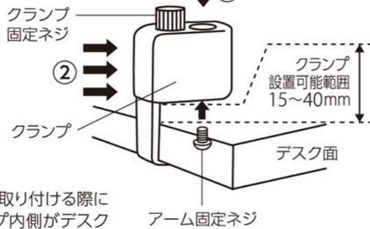
※クランプを取り付ける際には、クランプ内側がデスク面に収まるようにしてください。
