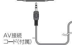
本機の外部出力端子とテレビの映像入力端子／音声入力端子を付属のAV接続コードで接続し、撮影した動画や画像をテレビモニターに映し出すことができます。接続中は本機のディスプレイ表示は消えますので、テレビを見ながら操作してください。
