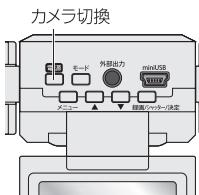
動画モード、画像モードでは、電源ボタンを押すたびに「カメラL+R」→「カメラL」→「カメラR」の順で切り換えることができます。
