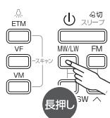
電源が切れているときにMW／LWボタンを長押しすると、電源オン時にMLボタンを押した際、LW放送を受信するか否かの切換ができるようになります。
