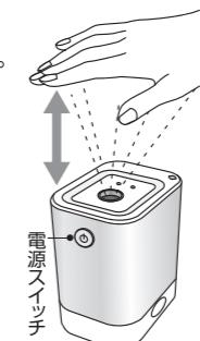
・破損の原因となりますので、電源スイッチは強く押し込まないでください。
