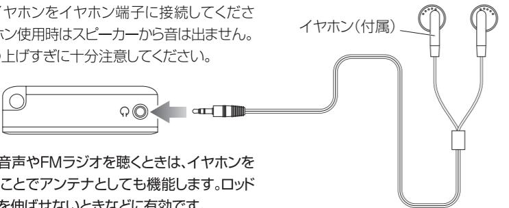
ワンセグ音声やFMラジオを聞くときは、イヤホンを接続することでアンテナとしても機能します。ロッドアンテナを伸ばせないときなどに有効です。
