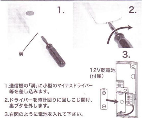
ボタンを押しても「呼び出し音」が鳴らないときは、新しい電池に交換して下さい。
