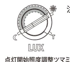
注意：点灯開始調整ツマミは必ず☾の範囲内に設定してください。“T”に回さないでください。(テストモードになり、“A”モードができなくなります)
