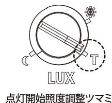
点灯開始照度調整ツマミを“T” (テスト) に回し、電源プラグをコンセントに差し込みます。ライトが点灯し、約60秒後に消灯します。消灯後、センサーが人を検知すると、周囲の明るさに関係なく再びライトが点灯し、約3秒後に消灯します。以上が“T” (テスト) モードでの正常な動作になります。センサーが検知せず点灯しない場合は、一度電源プラグを抜き、約2分後に再度電源プラグをコンセントに差し込んで“T” (テスト) モードで初期動作の確認をしてください。
