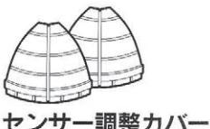
この部分をセンサー部周囲の溝に確実に差込む
