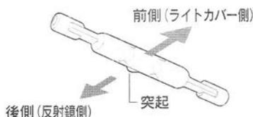
※ハロゲン電球は、突起がある方を後側(反射鏡)に向けて装着します。
