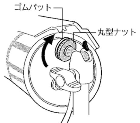
2. カメラスタンドは、カメラを設置する位置に、付属の木ネジで落下しないようにしっかりと固定してください。
