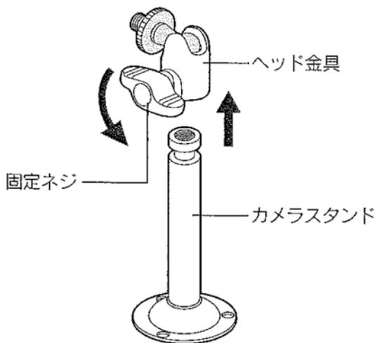
3. カメラ本体にヘッド金具の連結ネジを締め付け、丸型ナットを時計回りに回して固定します。カメラ本体とヘッド金具をしっかりと固定してください。
