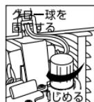
⑦グロー球の交換が終りましたら、外した外枠を正しい位置に戻します。
