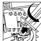
⑥片側の外枠を外してから、グロー球が確認できない場合は、外した外枠を戻してから、本体を回転させて反対側の外枠を外してください。新しいグロー球を差し込み、右方向に止まるまで回して、グロー球を固定します。
