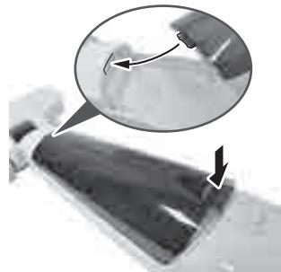
1 アウターフィルターにスponジフィルターを置き、フィルターカバーの突起部をアウターフィルターに差し込みます。
