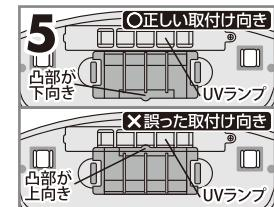
**5** ダストボックスを右図のように正しい取付け向きに取付けてください。
