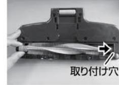
④回転部を取り付け穴にしっかりとめ込み、反対側も溝にはめます。
