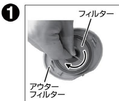
フィルターをアウターフィルター内に差し込み、時計回り側にしっかりと固定されるまで回します。
