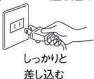
差し込みが不完全ですと感電・発熱による火災の原因になります。
