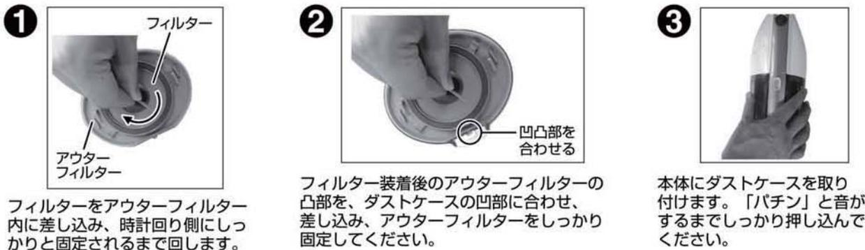
1 フィルターをアウターフィルター内に差し込み、時計回り側にしっかりと固定されるまで回します。
