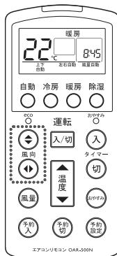
風向上下切換ボタンや風向左右切換ボタンを数回押して、お好みの風向に調節します。
