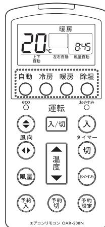
自動、冷房、暖房、除湿のいずれかのボタンを押すと、その運転モードに切り換わります。
