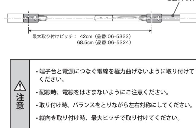
&lt;縦向き取り付け&gt; ※最大取り付けピッチは横向きと同様です。
