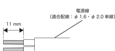
(3) 電源線を端子台に確実に差し込む。
