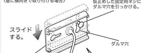
(3) 二つの取り付けベースがまっすぐになるか確認し、仮止めした固定用ネジを締め付ける。
