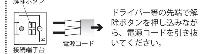
ドライバー等の先端で解除ボタンを押し込みながら、電源コードを引き抜いてください。
