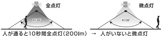
モード2(裏面のLED常夜灯が2回点滅後点灯)
