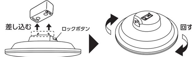
器具を外す際は、ロックボタンを押しながら落下しないように手を添えて、反時計回りに回して取り外してください。
