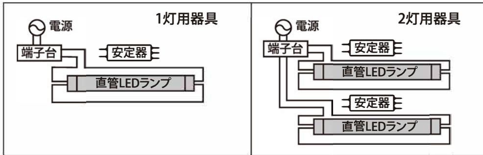
※上図の配線によりランプの取り付け方向がなくなります。どちらの方向でランプを取り付けてもドライバーへ電源が供給されます。
