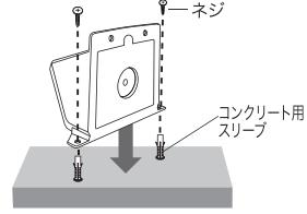
取付穴をネジで塀に固定します。
