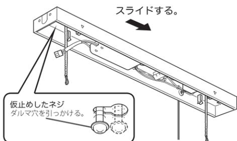
(4) 反対側のネジ取付用穴をネジ(付属品)で固定する。
