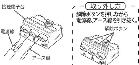
(3) 余分な電源線、アース線を電源穴に押し込むか、電源線を器具本体に押し付けて配線する。
