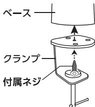
ベース底面に付いている付属ネジを外し、ベース底面にある位置合わせ用ガイド突起を、クランプ上面にあるガイド穴に合わせ、付属の六角レンチを使って付属ネジを緩みのないように固定してください。
