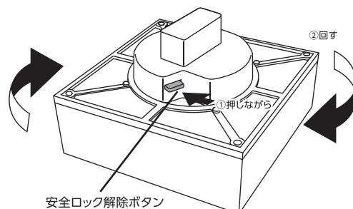
**注意** ボタンを押さずに回すと引掛シーリングが破損します。
