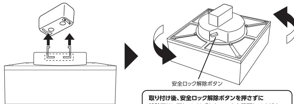
取り付け後、安全ロック解除ボタンを押さずに時計回りに回して、はずれないことを確認してください。
