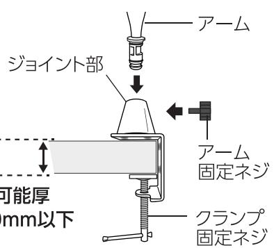
② クランプ固定ネジをしっかりと締めて、テーブルに固定します。
