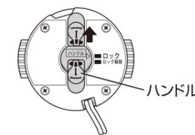
**ポイント** 取り付け後、黒いボタンを押さずに左に回して、はずれないことを確認してください。
